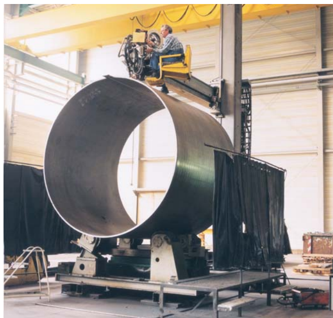
Wytwarzanie wież elektrowni wiatrowych przy pomocy systemu słupowysięgników
